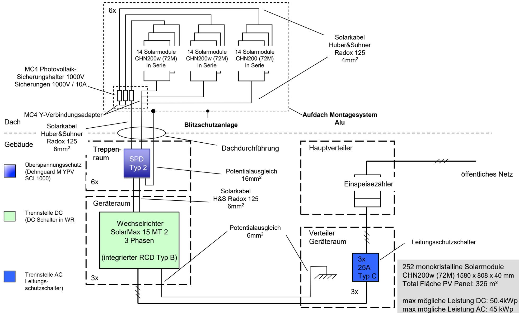
**Prinzipschema Photovoltaik Anlage
